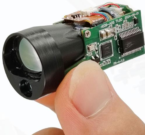
该产品以人眼安全的905nm半导体激光器为基础，采用TDC+AD，具有体积小，重量轻，测量距离长等特点，广泛应用于小型无人机吊舱、多光谱红外望远镜、夜视仪、瞄准镜等设备集成。
