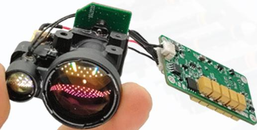
模块采用1535nm铒玻璃泵浦激光器组件，具有测量距离远、功耗低、性能稳定、对人眼安全等特点。优异的高低温性能可在恶劣环境下持续使用，广泛应用于无人机吊舱，安防云台，热成像，多光谱望远镜，瞄准镜等设备集成。
