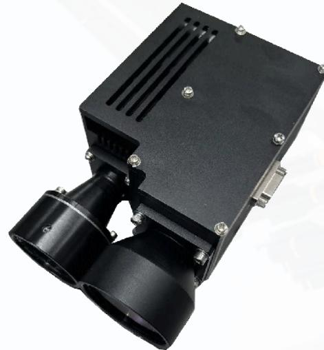
模块采用1570nm OPO激光器组件,具有测量距离远、性能稳定、眼睛安全等特点，是舰载,陆基地对空/对海,船载等高防护等级设备集成的最佳选择。其地对空测量无人机性能卓越。
