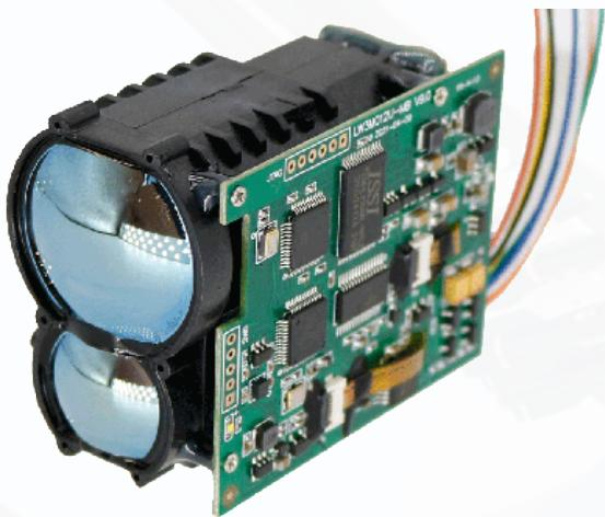
该产品以人眼安全的905nm半导体激光器为基础，采用TDC+AD，具有体积小，重量轻，测量距离长等特点，广泛应用于无人机吊舱、多光谱红外望远镜、夜视仪、安防云台等设备集成。
