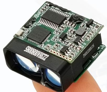
该产品以人眼安全的905nm半导体激光器为基础，采用SWaP，具有体积小，重量轻，测量距离长等特点，广泛应用于微小型无人机定高、手持测距仪、多光谱望远镜、瞄准镜等设备集成。
