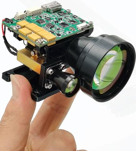
模块采用1535nm眼睛安全激光器组件，具有测量距离远、功耗低、性能稳定等特点，广泛应用于无人机吊舱，无人车，安防云台，热成像等设备集成。通过RS422/RS232/TTL串口连接，便于二次开发
